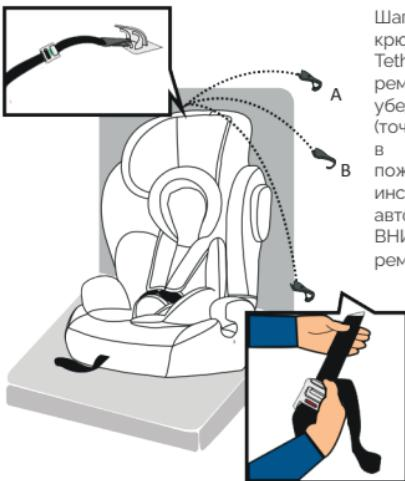
Шаг 4: Откройте крышку, закрывающую крюк для крепления якорного ремня Топ Теттер, в автомобиле, прикрепите крючок ремня Топ Теттер к точке крепления и убедитесь, что ремень полностью натянут. (точки крепления крючка могут отличаться в зависимости от типа автомобиля, пожалуйста, прочтайте внимательно инструкцию по эксплуатации вашего автомобиля).
