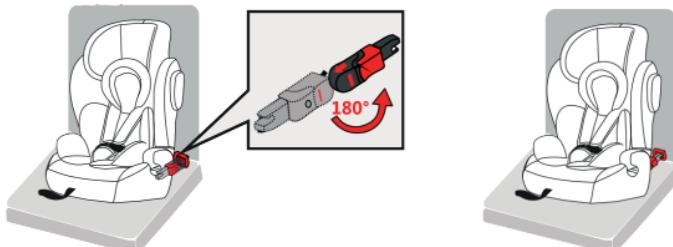
Шаг 2: Поверните фиксаторы Isofix до щелчка. Проверьте, что фиксаторы Isofix двигаются в пределах угла 15°, и не могут поворачиваться.
