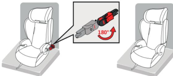
Шаг 2: Поверните фиксаторы Isofix до щелчка. Проверьте, что фиксаторы Isofix двигаются в пределах угла 15°, и не могут поворачиваться.
