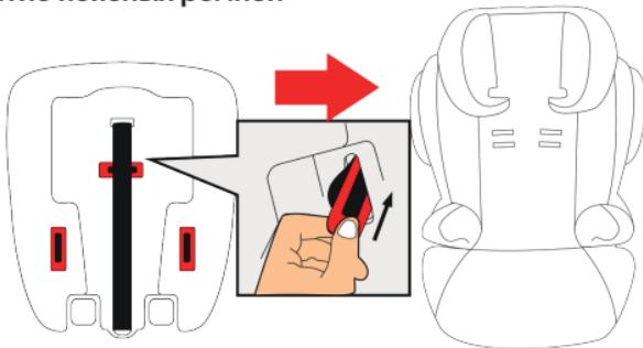
Поверните фиксаторы ремней узкой стороной и протолкните их в прорези в основании детского автокресла и затем в прорези в тканевом чехле.
