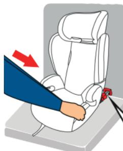
Шаг 3: Затем снимите черную пластиковую крышку фиксаторов Isofix, чтобы вставить крепления Isofix в красные отверстия приемных приспособлений. Красный цвет означает, что крепления Isofix не зафиксированы. Прижмите базу Isofix к месту креплений и убедитесь, что база Isofix зафиксирована. Убедитесь, что индикатор на креплениях Isofix показывает зеленый цвет.
