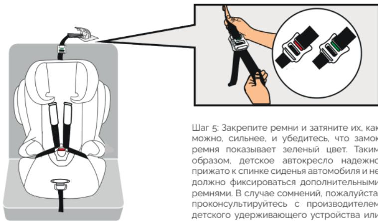
Шаг 5: Закрепите ремни и затяните их, как можно, сильнее, и убедитесь, что замок ремня показывает зеленый цвет. Таким образом, детское автокресло надежно прижато к спинке сиденья автомобиля и не должно фиксироваться дополнительными ремнями. В случае сомнений, пожалуйста, проконсультируйтесь с производителем детского удерживающего устройства или продавцом.
